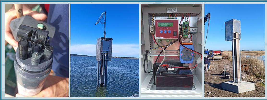
Dettaglio della sonda Vista della Stazione B Data logger Struttura di sostegno
